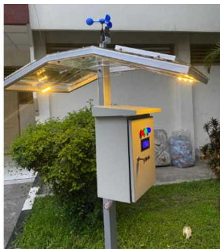
Gambar 3 Prototipe sistem monitoring dan logging data stasiun cuaca
