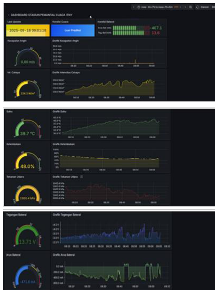
Gambar 4 Tampilan Dashbord Stasiun Pemantau Cuaca secara Real time
