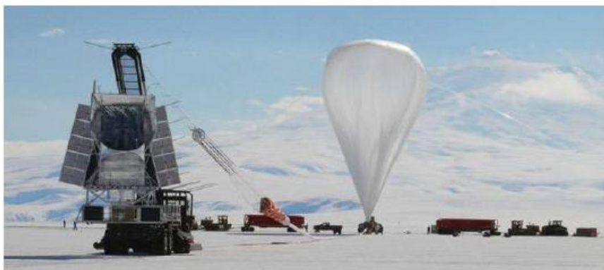
Gambar 1 Balloon-borne Large Aperture Submillimeter Telescope (BLAST) yang merupakan salah satu contoh dari platform HAPS (Northwestern Edu, 2024)
