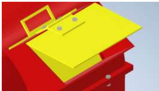
Gambar 6. Sekat Pembatas dan Jalur Inputan Plastik
