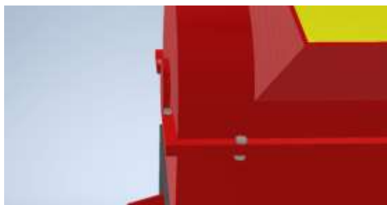
Gambar 7. Penggunaan Baut untuk Konsep Knockdown
