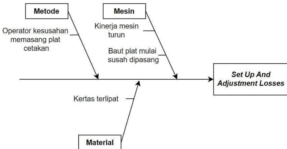
Gambar 1. Diagram Fishbone penyebab Losses pada mesin SM 52
