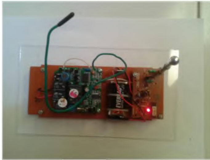
Gambar 4. Rangkaian sensor getar dan transceiver
