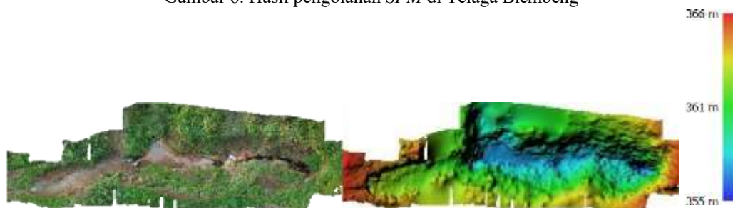
Gambar 7. Hasil pengolahan SFM di area sinkhole Telaga Blembeng
