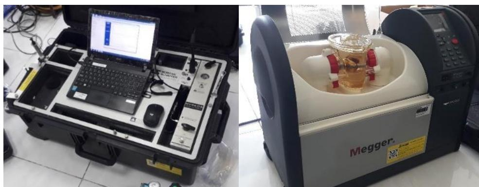
Gambar 1. Alat pengujian DGA dan BDV
