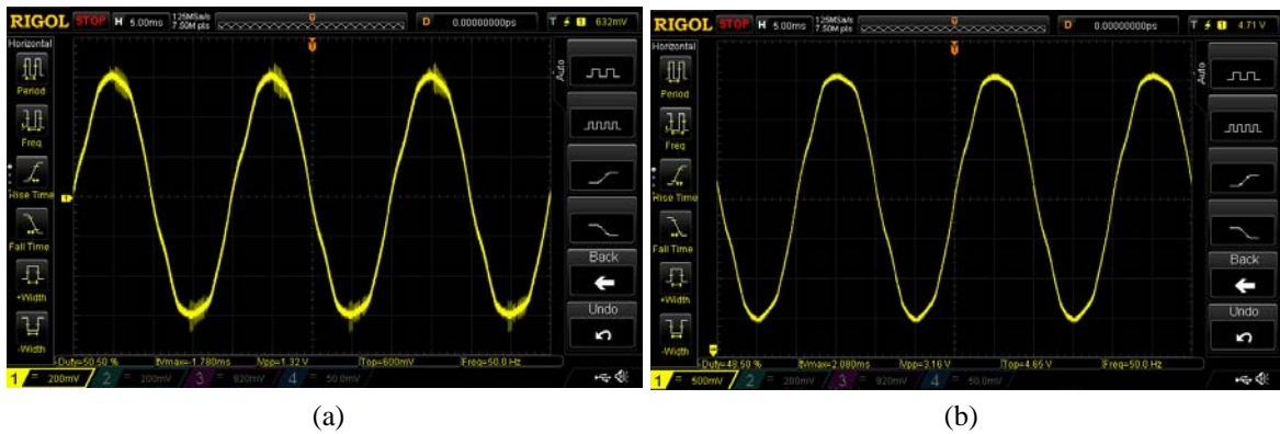
Gambar 7. Keluaran penguat sensor arus (a) sebelum dan (b) sesudah penguatan
