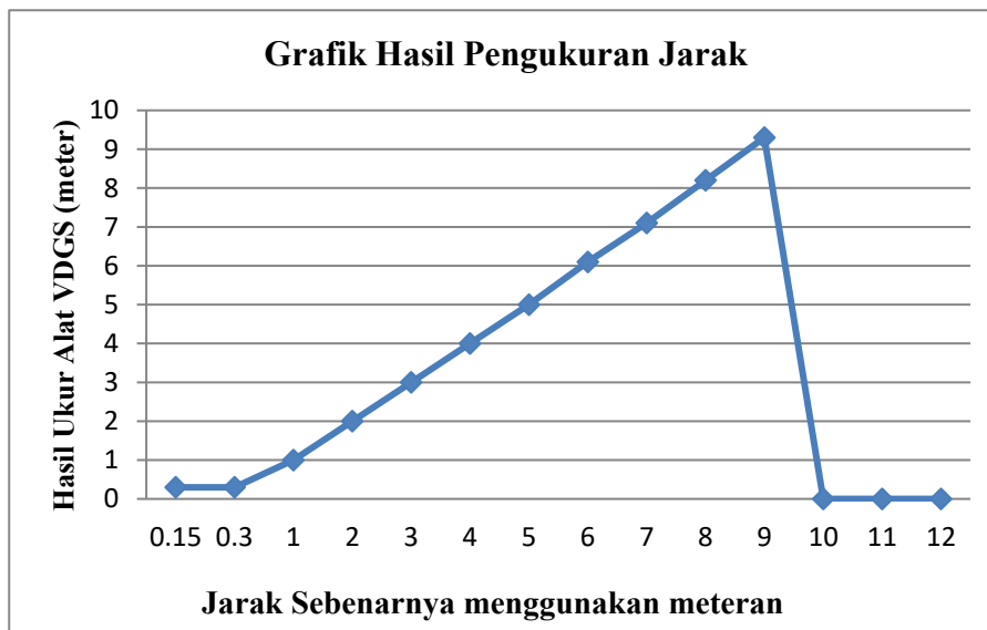
Gambar 13. Grafik Hasil Perbandingan Pengujian Sensor Lidar Terhadap Obyek Pesawat Pitts S2C.
