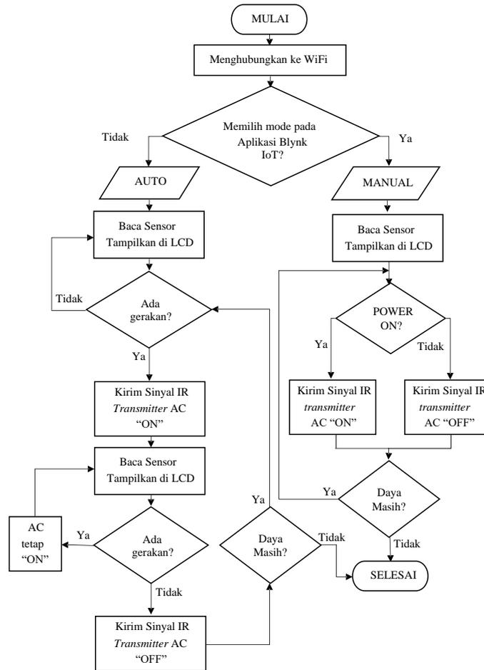
Gambar 3. Flowchart cara kerja sistem pengendali AC
