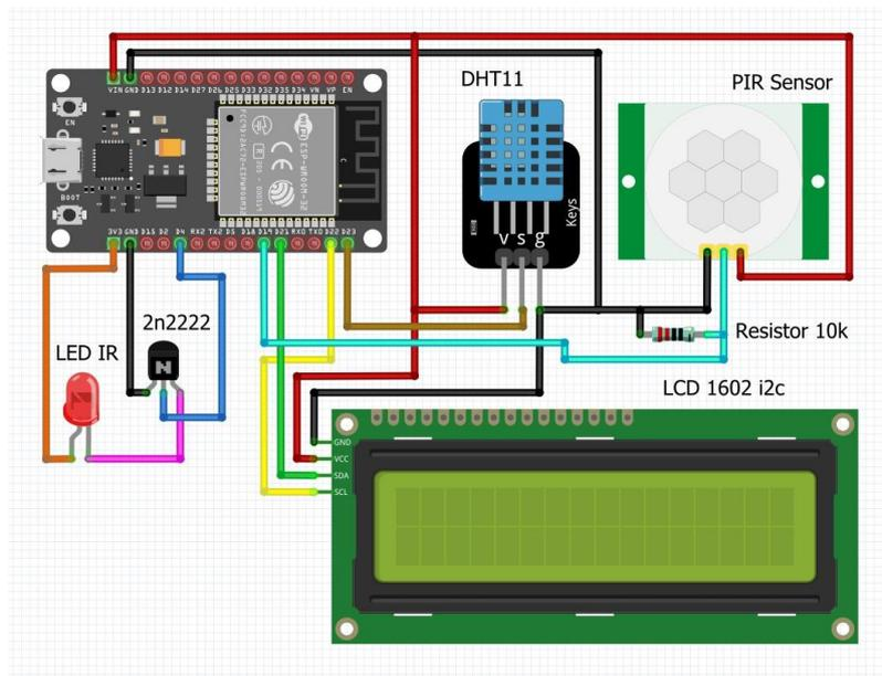
Gambar 2. Skema rangkaian komponen alat pengendali AC
