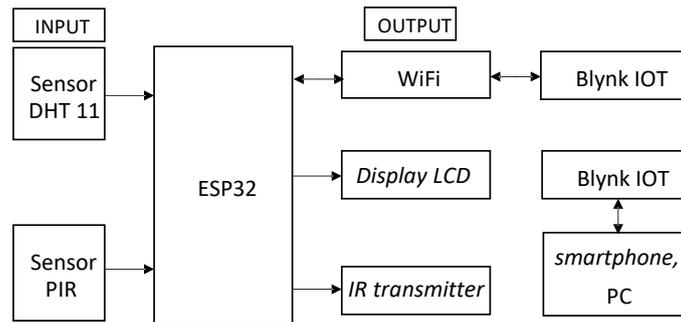
Gambar 1. Blok diagram perancangan sistem
