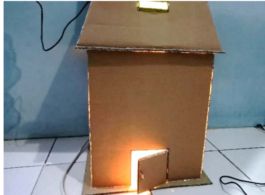
Gambar 8. Kondisi lampu menyala ketika suhu di dalam kandang <30^{\circ}\text{C}
