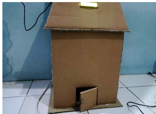
Gambar 9. Kondisi lampu mati ketika suhu di dalam kandang >38^{\circ}\text{C}
