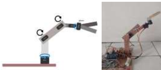
Gambar 3. Desain awal robot lengan
