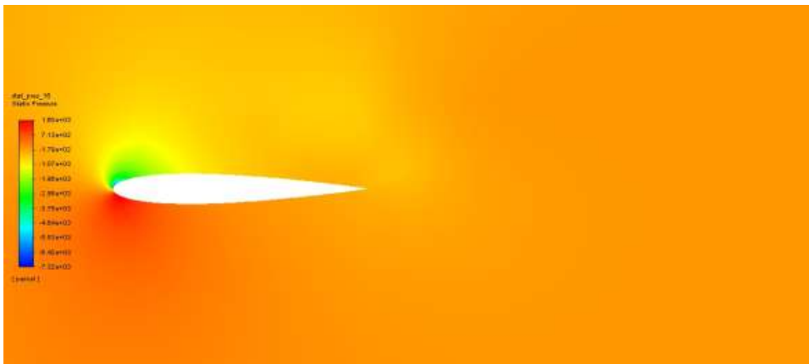
Gambar 11 Kontur tekanan Fluent saat 15 derajat
