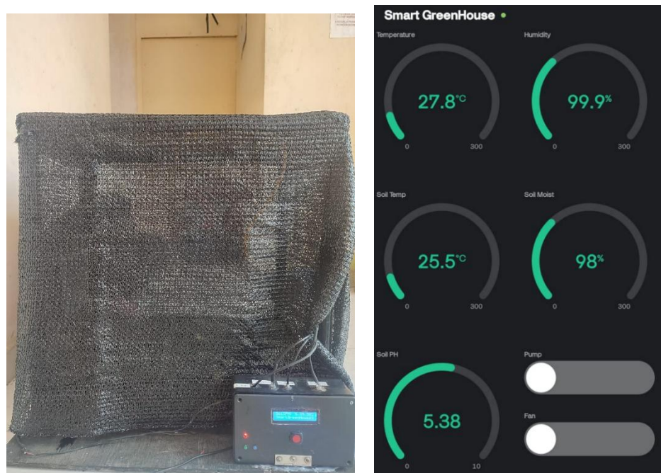
Gambar 9. Sistem Tidak Aktif Berdasarkan Pembacaan Sensor
