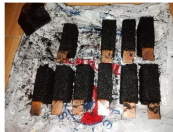
Gambar 2. Aluminium Air Battery yang telah dibentuk
