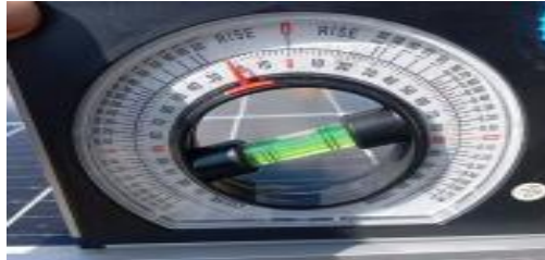
Gambar 2. Pengukuran Sudut Kemiringan pada Panel surya
