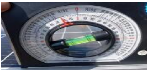
Gambar 2. Pengukuran Sudut Kemiringan pada Panel surya
