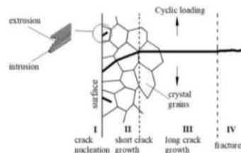
Gambar 1. Proses kelelahan pada pembebanan siklik [4].
