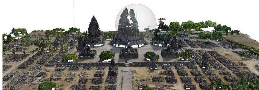
Gambar 4. Tahapan pengolahan foto udara dari sisi atas (a) proses align photo dan (b) proses build dense Gambar 5 di bawah ini menampilkan proses align photo dan build dense pada foto yang diambil dari sisi samping.
