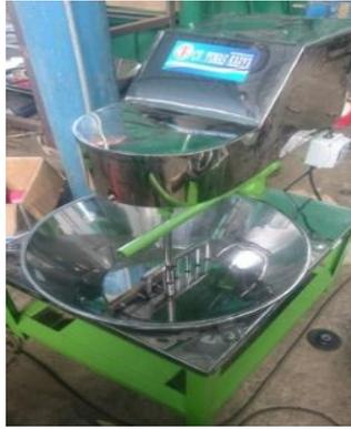
Gambar 1 Mesin Pemasak Nira
