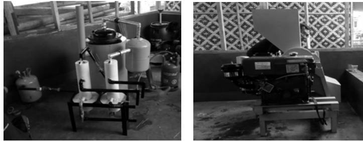
Gambar 1. Satu set peralatan pirolisis dan mesin pencacah
