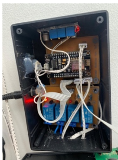
Gambar 9. Pemantau suhu oven compression plastik
