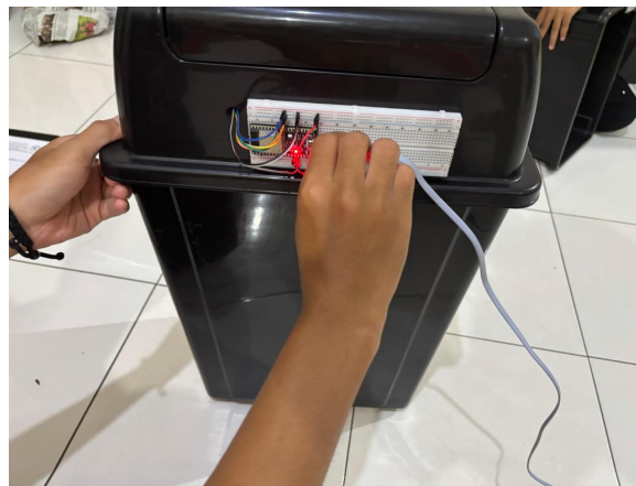
Gambar 4. Instalasi Rangkaian Sistem pada Tempat Sampah Pintar
