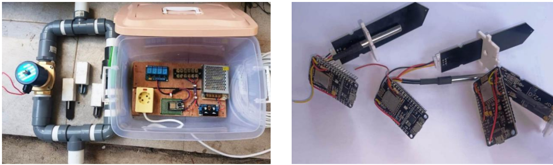
Gambar 4. Perangkat sistem irigasi tetes otomatis; sensor kelembaban dan suhu tanah
