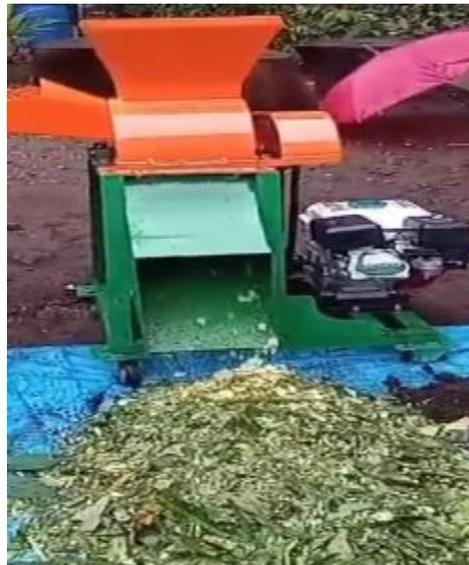
Gambar 6. Mesin Pencacah Rumput Odot
