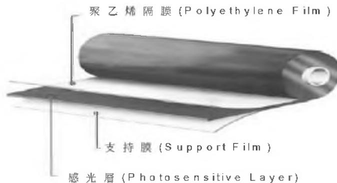
Gambar 3. Struktur *Dry Film Photoresist*
