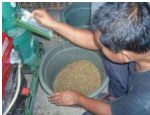
Gambar 5. Proses pemisahan pelet kering dan basah.
