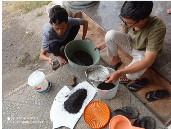
Gambar 5. Proses penumbukan arang
