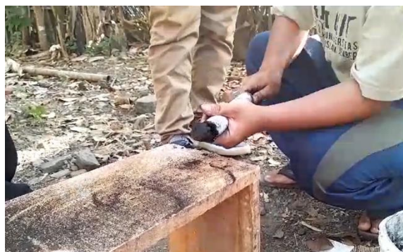
Gambar 9. Proses pencetakan bio-briket
