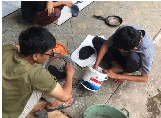
Gambar 8. Proses pencampuran kanji dan bubuk arang
