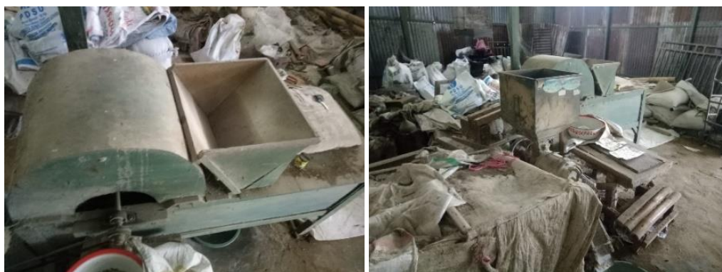
Gambar 2. Kondisi mesin penggiling padi yang lama
