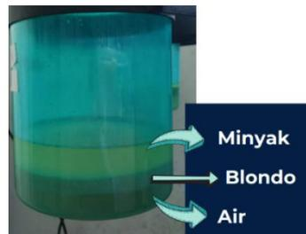
Gambar 10. Proses pembentukan minyak, blondo, dan air
