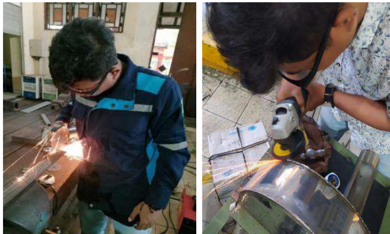
Gambar 5. Proses pemotongan dan penggerindaan mesin
