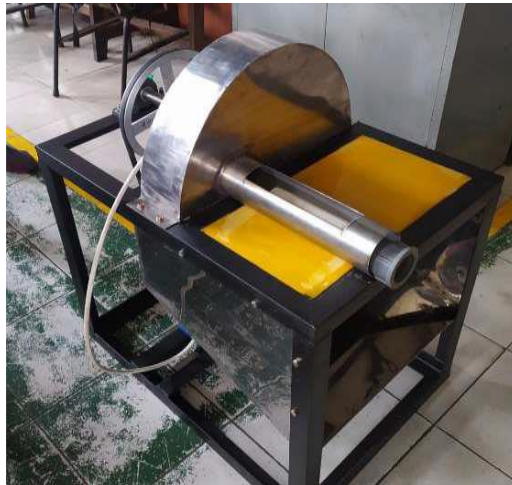
Gambar 9. Mesin pengiris singkong yang sudah digabungkan komponen-komponennya.
