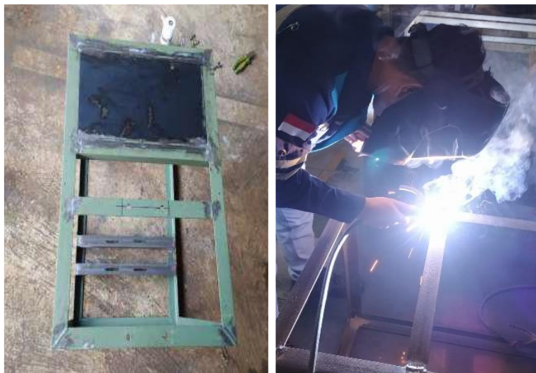
Gambar 7. Proses pembuatan rangka mesin pengiris singkong
