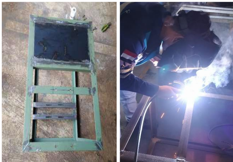
Gambar 7. Proses pembuatan rangka mesin pengiris singkong
