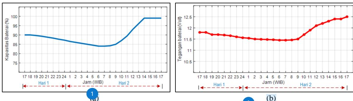
Gambar 8. Hasil pengukuran baterai, (a) Kapasitas baterai, (b) tegangan baterai
