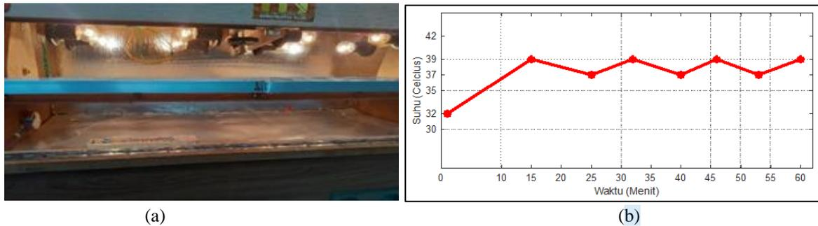
Gambar 9. Pengukuran suhu mesin tetas. (a) penempatan thermometer dalam mesin tetas, (b) Hasil pengukuran
