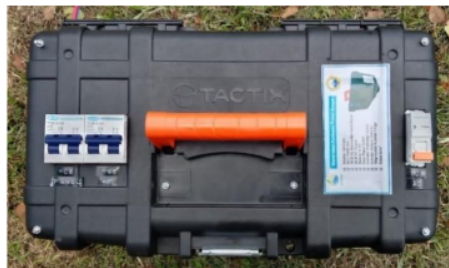
Gambar 3. Bentuk jadi dari generator portable tenaga surya tampak atas
