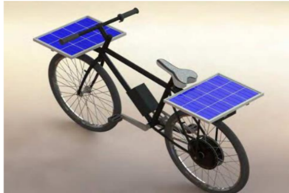
Gambar 5. Pemanfaatan solar cell pada sepeda listrik (Sumber : Nainggolan dkk, 2016).
